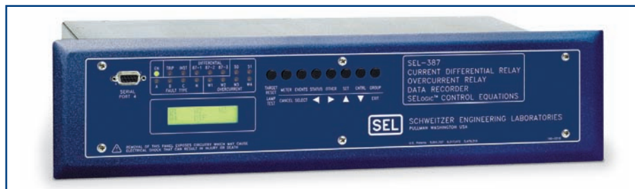
Terminal numeric pentru protecția diferențială și maximală de curent SEL-387
